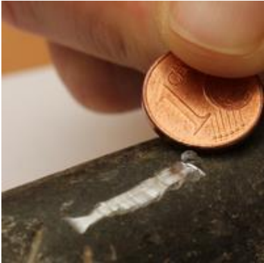
Links: So erkennen Sie eine Bleileitung: Blei ist weich, lässt sich leicht biegen und schon mit einer Münze anritzen. Rechts: Blei trifft Kupfer - in diesem Haus wurde nur teilsaniert. Bilder mit freundlicher Genehmigung von www.nlga.niedersachsen.de .
